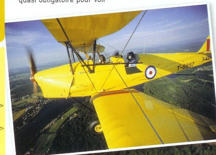
Bien que ne disposant que de deux ailerons sur les ailes basses, le Tiger Moth est manœuvrant.
