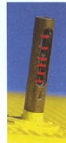
Un simple flotteur tubulaire en laiton gradué sert de jauge.
