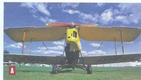
**A** - Vérifier de face si les ailes et le haubanage sont symétriques. Une asymétrie peut indiquer un avion fatigué ou qui été un peu trop secoué. Il existe aussi une procédure plus complexe à mettre en œuvre. Celle-ci consiste à placer sur support fixe l'appareil en ligne de vol et à mesurer différents points par rapport au sol.
